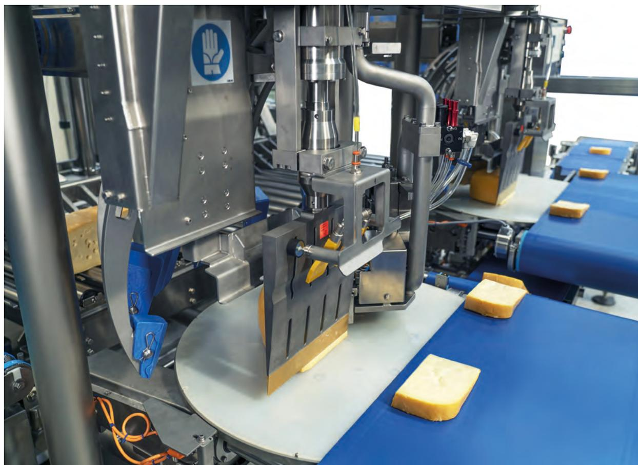
Produttività, versatilità e precisione dotata di un sistema di taglio ad ultrasuoni per lavorare formaggi a pasta tenera di diverse dimensioni (Mod. con doppia perforazione e doppia testata di taglio).
