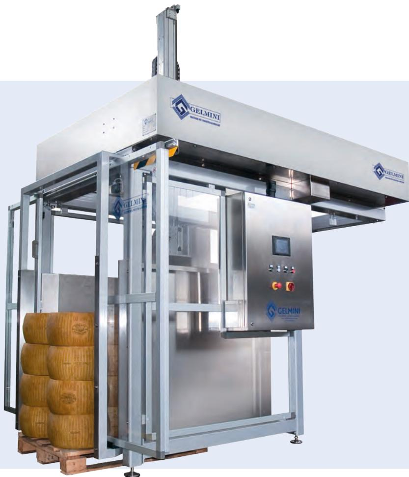
Il robot caricamento forme è una macchina per movimentare le forme di formaggio alloggiare su europallet, indicata per alimentare la Discatrice Mod. GEA.
