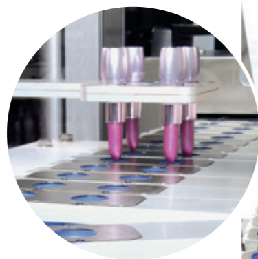
Smodellaggio stick Stick demoulding
