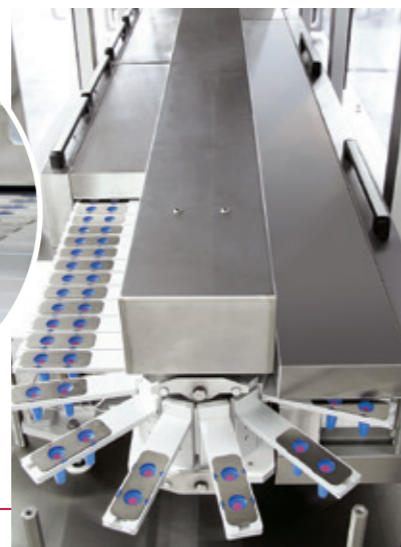
Tunnel di raffreddamento a 3 zone di temperatura
